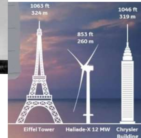
2019 : Halliade-X Puissance : 12 mW Premiers tests en mer du Nord
